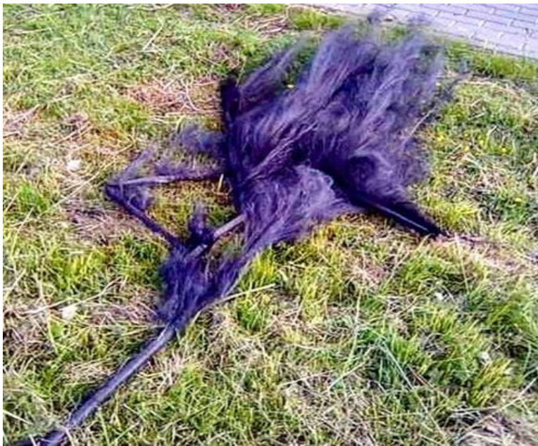
Углепластиковая удочка, после воздействия электрического тока.
